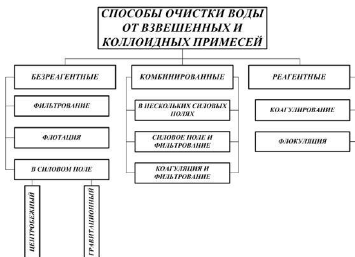
Рис. 1. Классификация способов очистки воды от взвешенных и коллоидных примесей
