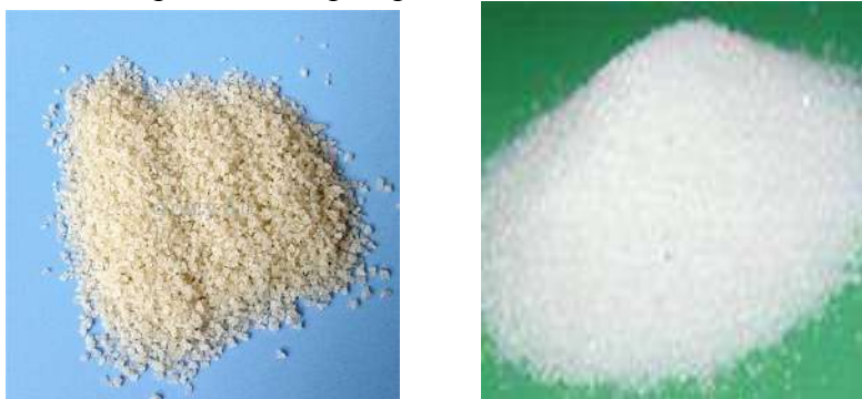
Рис.1. Модифицированный флокулянт на основе полиакриламида
